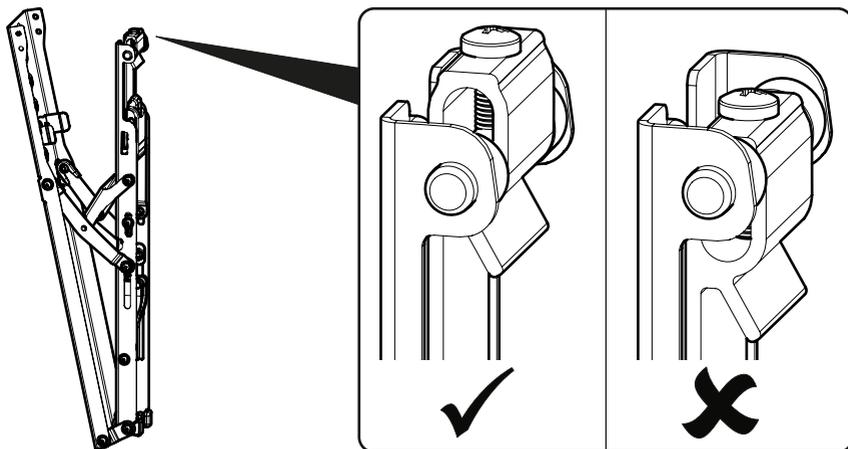
Para garantizar una inclinación máxima luego de la instalación, deberá asegurarse de que la TV no choque contra la pared.
