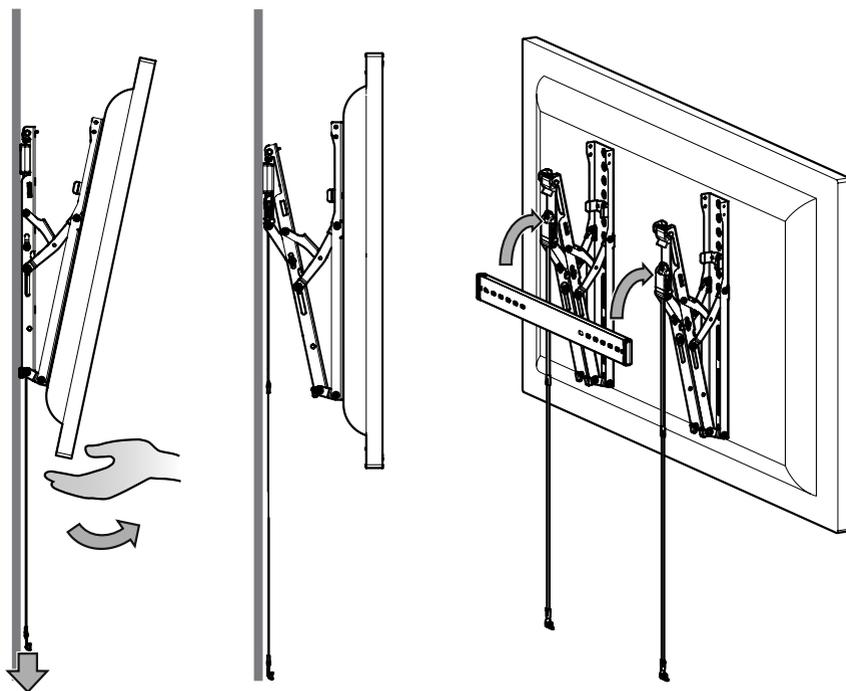
Jale simultáneamente de ambas cuerdas de desenganche de la TV para destrabar la TV. Aleje la base de la TV de la pared, de modo que el pestillo no se vuelva a trabar. Levante y quite la TV de la guía de la pared.
