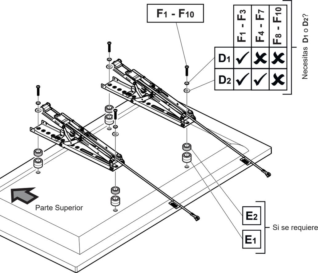
Coloque los soportes a la parte posterior de su TV usando la combinación adecuada de tornillo, reductor y espaciador.
