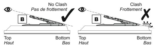
If a clash is observed you will need to use adaptors **C** to position the TV Brackets **B** closer to the bottom of the TV to achieve maximum tilt. Si un conflit est observé, vous aurez besoin d'utiliser les adaptateurs **C** pour positionner les supports **B** plus près du fond de la TV pour atteindre inclinaison maximale.
