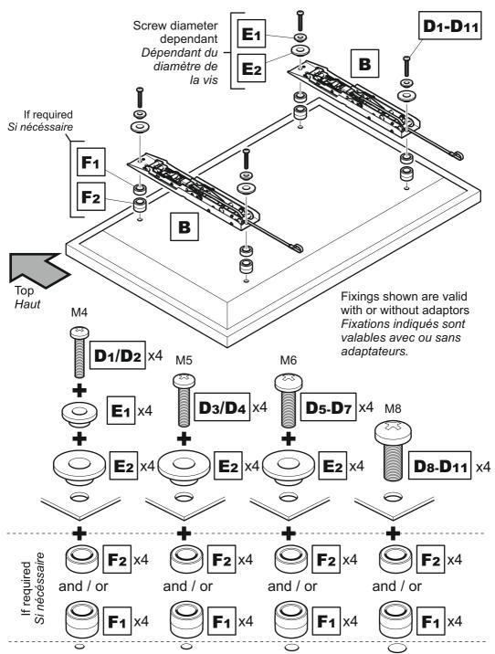
Attach the bracket to the back of your TV using suitable screw, reducer and spacer combinations Attachez l'applique au dos de votre téléviseur en utilisant une combinaison de vis, de séparateurs et de joints adaptés
