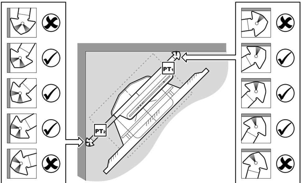
Puede girar **PT<sub>2</sub>** 180° y voltear **PT<sub>1</sub>** para que su TV pueda moverse aún más en otra dirección. El ejemplo le muestra cómo obtener mayor movimiento hacia la izquierda, si se intercambian **PT<sub>1</sub>** y **PT<sub>2</sub>**.
