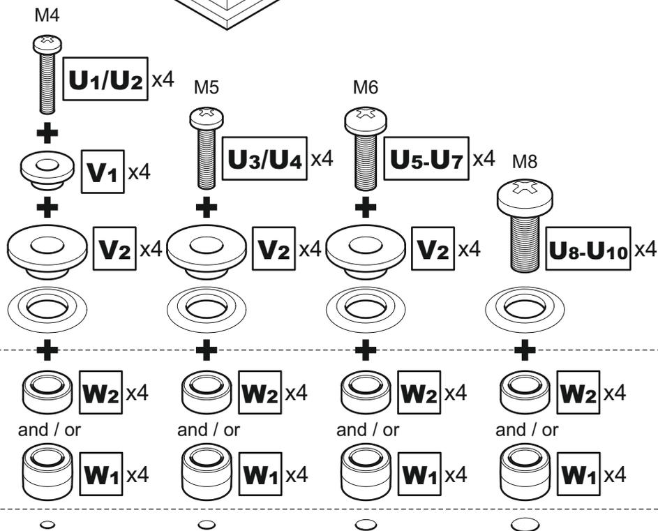
Coloque los soportes a la parte posterior de su TV usando la combinación adecuada de tornillo, reductor y espaciador.
