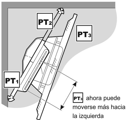
**vi** Gire y deslice **PT<sub>3</sub>** para asegurarse que no haya colisiones. Asegúrese siempre que el orificio esté dentro de la ranura, ver paso **iv**.
