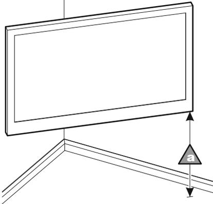
**ii** Mesurez à partir du dessous du support **B2** jusqu'au bas du support de votre télé (dimension  $\triangle b$ )
