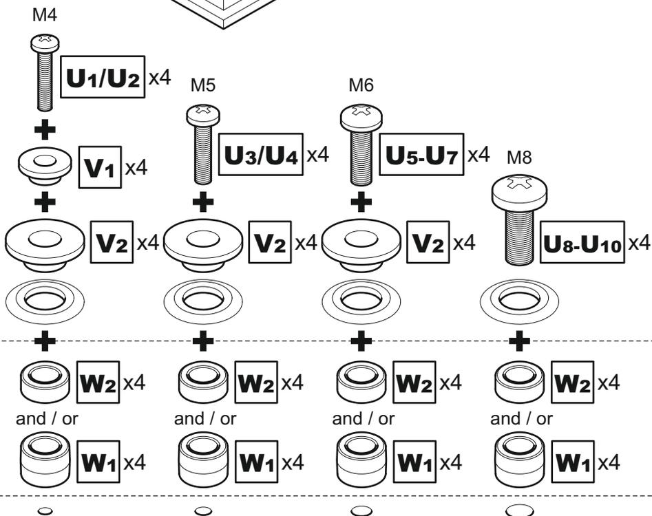
Attachez l'applique au dos de votre téléviseur en utilisant une combinaison de vis, de séparateurs et de joints adaptés
