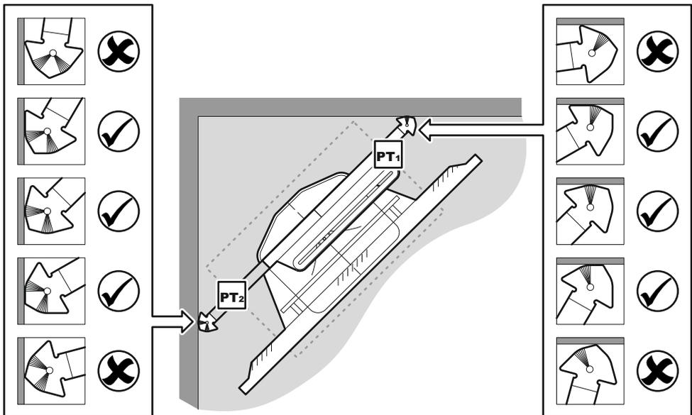
Vous pouvez tourner **PT<sub>2</sub>** à 180° et retourner **PT<sub>1</sub>** afin que votre télé aille plus loin, dans une autre direction. L'exemple démontre comment vous pouvez obtenir davantage de mouvement vers la gauche en permutant **PT<sub>1</sub>** et **PT<sub>2</sub>**.
