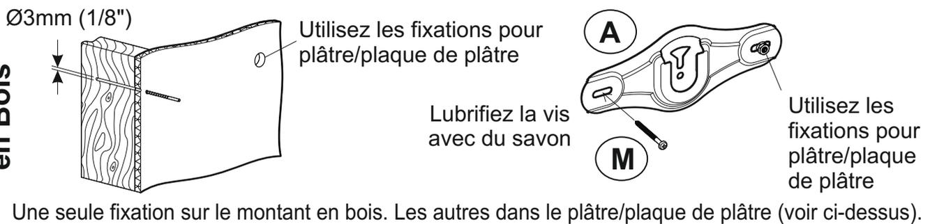
Une seule fixation sur le montant en bois. Les autres dans le plâtre/plaque de plâtre (voir ci-dessus).
