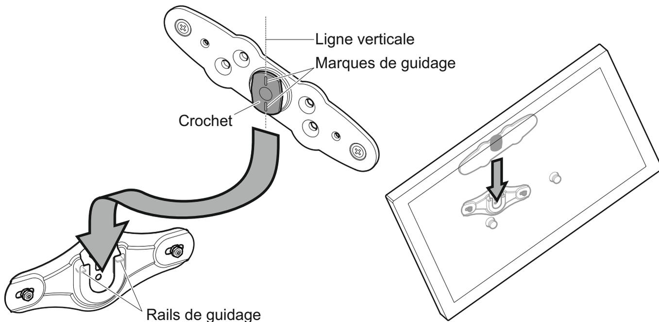
Penchez votre TV jusqu'à ce que les marques de guidage soient à la verticale. Ensuite, glissez votre TV vers le bas afin que les accroches s'insèrent dans les deux rails de guidage du support. Assurez vous que les accroches soient totalement engagées et inclinez votre TV dans le sens des aiguilles d'une montre jusqu'à ce qu'elle soit nivelée.
