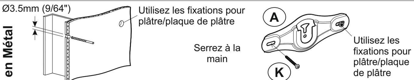
Une seule fixation dans le montant en métal. Les autres dans le plâtre/plaque de plâtre (voir ci-dessus).
