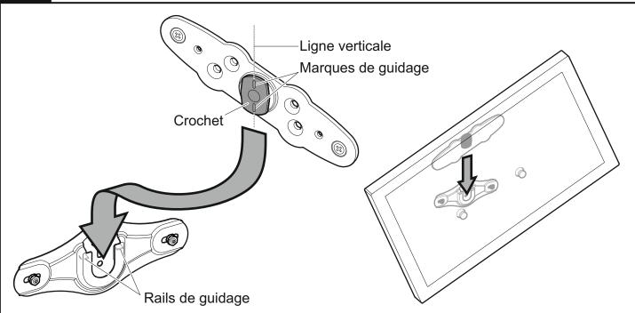
Penchez votre TV jusqu'à ce que les marques de guidage soient à la verticale. Ensuite, glissez votre TV vers le bas afin que les accroches s'insèrent dans les deux rails de guidage du support. Assurez vous que les accroches soient totalement engagées et inclinez votre TV dans le sens des aiguilles d'une montre jusqu'à ce quelle soit niveléel.
