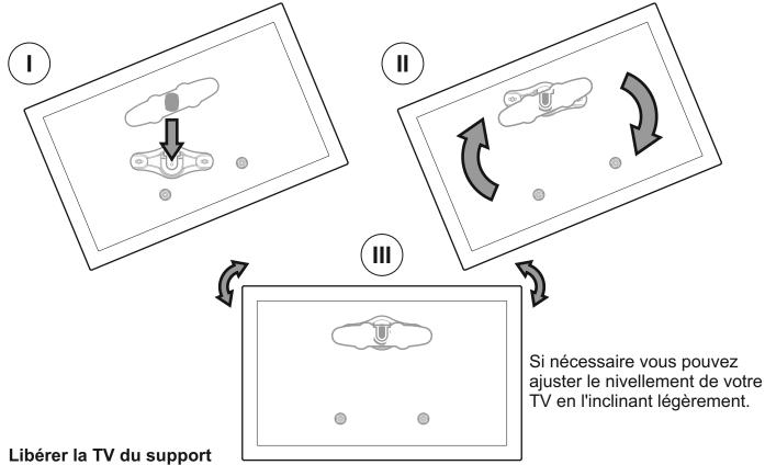
C'est un travail nécessitant deux personnes. Pour retirer la TV, l'incliner de 15 à 30° dans le sens inverse des aiguilles d'une montre, la soulever pour la libérer (NB : Inversez les mouvements comme cela est décris)
