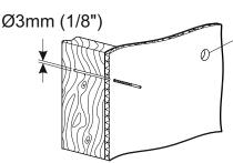
Utilisez les fixations pour plâtre/plaque de plâtre
