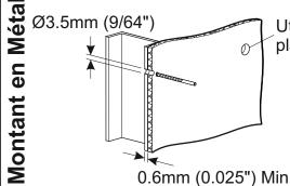
Utilisez les fixations pour plâtre/plaque de plâtre
