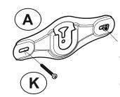
Utilisez les fixations pour plâtre/plaque de plâtre
