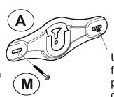
Utilisez les fixations pour plâtre/plaque de plâtre
