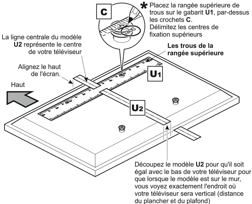
\* Si les crochets **C** ne sont alignés avec aucun des trous du gabarit, alors assurez-vous que ce dernier est bien en place, puis poinçonnez 2 trous avec un crayon ou un objet pointu de sorte qu'ils correspondent avec les centres de fixation supérieurs.
