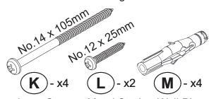
Long Screw Metal Stud Wall Plug Screw
