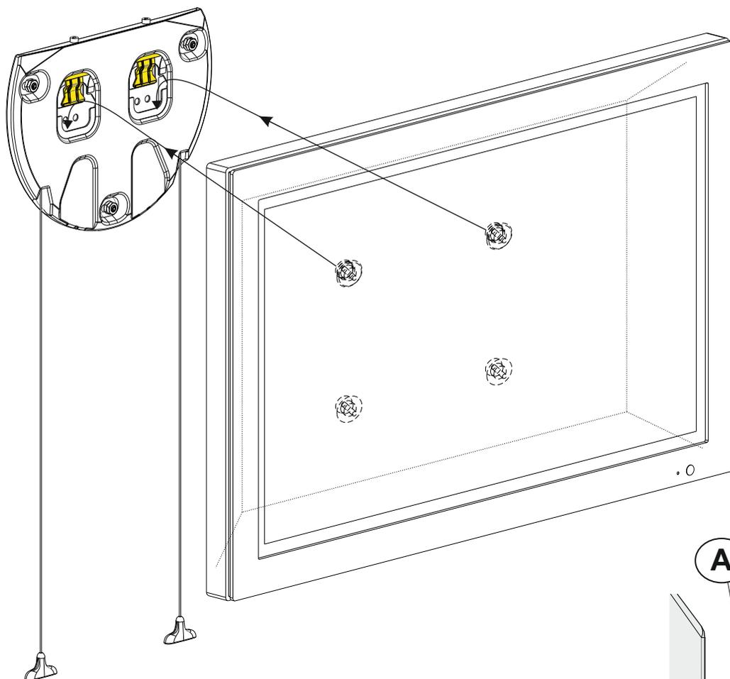
Poussez les crochets jaunes (à l'arrière du téléviseur) dans le réceptacle jaune des crochets muraux. Glissez pour mettre en place. Assurez-vous que les crochets jaunes sont bien engagés. Si les câbles du téléviseur empêchent celui-ci d'être appuyé contre le mur, envisagez une autre fixation (voir section 9).
