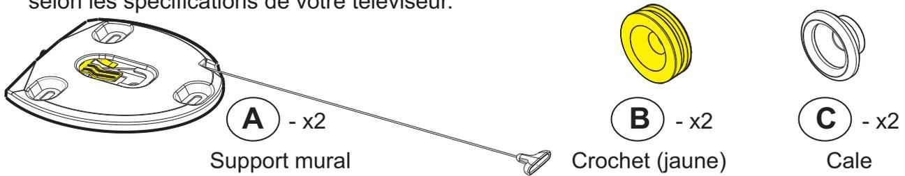
**Fixations du téléviseur :** les éléments se fixent à l'arrière du téléviseur (selon le type de téléviseur, voir section 11)
