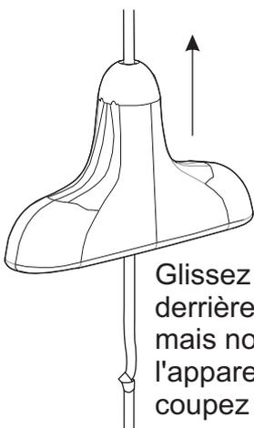
Glissez les fixateurs de câbles derrière le téléviseur (accessibles mais non visibles de l'avant de l'appareil). Nouez le fixateur et coupez l'excédent.
