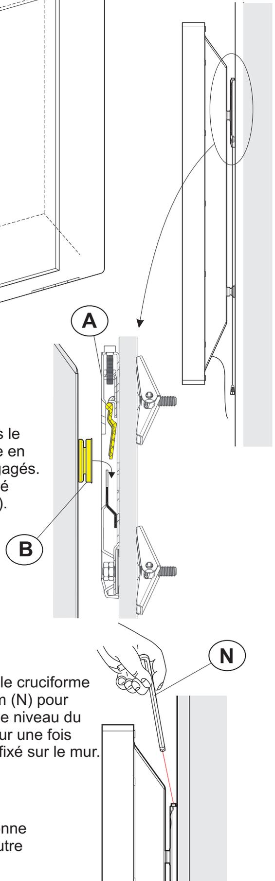
Utilisez le cruciforme de 3 mm (N) pour ajuster le niveau du téléviseur une fois celui-ci fixé sur le mur.
