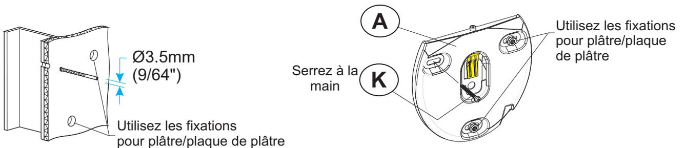
Une seule fixation dans le montant en métal. Les autres dans le plâtre/plaque de plâtre (voir ci-dessus).
