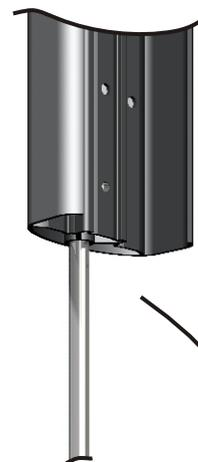
NOTE: - ALIGNEZ LE BORD DU TROU SUR LE BORD DE LA PIECE (I) POUR FACILITER L'ALIGNEMENT ET L'INTRODUCTION DE LA VIS SANS TETE (T7).
