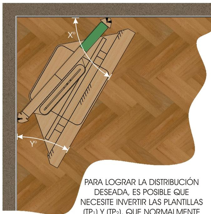
PARA LOGRAR LA DISTRIBUCIÓN DESEADA, ES POSIBLE QUE NECESITE INVERTIR LAS PLANTILLAS (TP<sub>1</sub>) Y (TP<sub>2</sub>), QUE NORMALMENTE SE HACE SI EL ÁNGULO "X" ES SUPERIOR AL ÁNGULO "Y", COMO MUESTRA EL EJEMPLO
