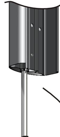
NOTA: - ALINEE EL BORDE DEL AGUJERO DE LA PIEZA (I) PARA FACILITAR LA ALINEACIÓN E INSERCIÓN DEL TORNILLO SIN CABEZA (T7)
