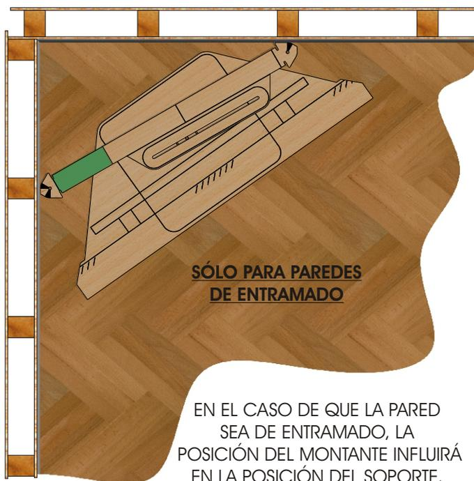
EN EL CASO DE QUE LA PARED SEA DE ENTRAMADO, LA POSICIÓN DEL MONTANTE INFLUIRÁ EN LA POSICIÓN DEL SOPORTE. UTILICE LAS PLANTILLAS PARA COMPROBAR LA POSICIÓN Y DETERMINAR LA INSTALACIÓN IDEAL DE LOS MONTANTES QUE VA A UTILIZAR
