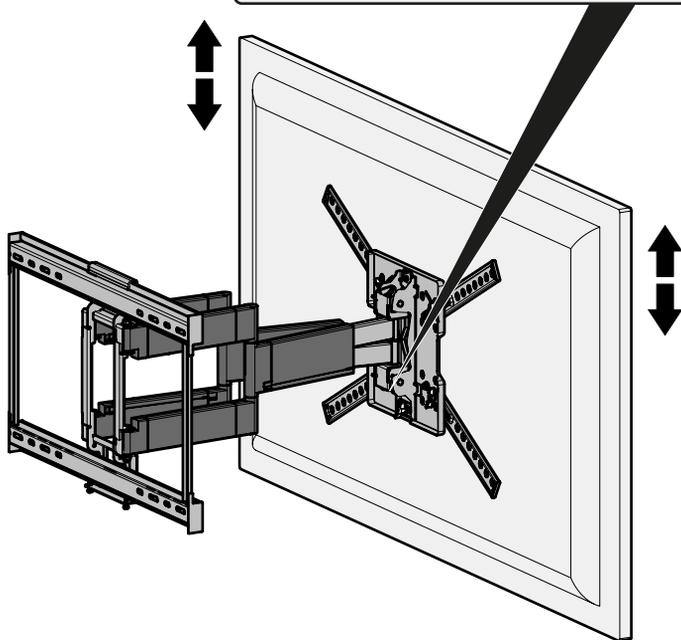
Desserrez la vis de serrage du niveau, ajustez votre téléviseur au niveau souhaité, puis resserrez la vis.
