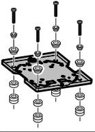
Si la norme VESA du téléviseur est de 200 x200 mm ou moins, utilisez les trous de la plaque de montage du téléviseur.
