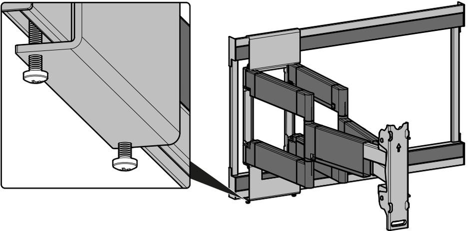
Glissez le bras en position et resserrez les deux vis de serrage.
