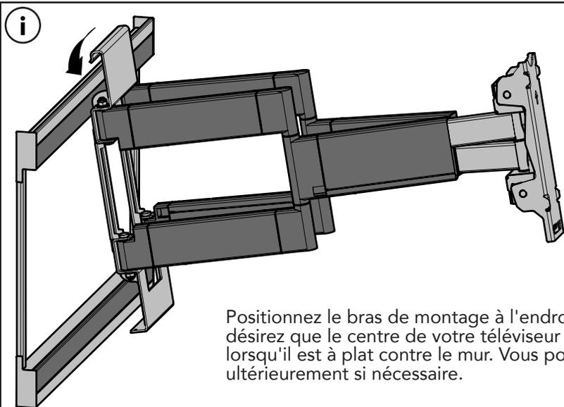
Positionnez le bras de montage à l'endroit où vous désirez que le centre de votre téléviseur soit placé, lorsqu'il est à plat contre le mur. Vous pouvez l'ajuster ultérieurement si nécessaire.
