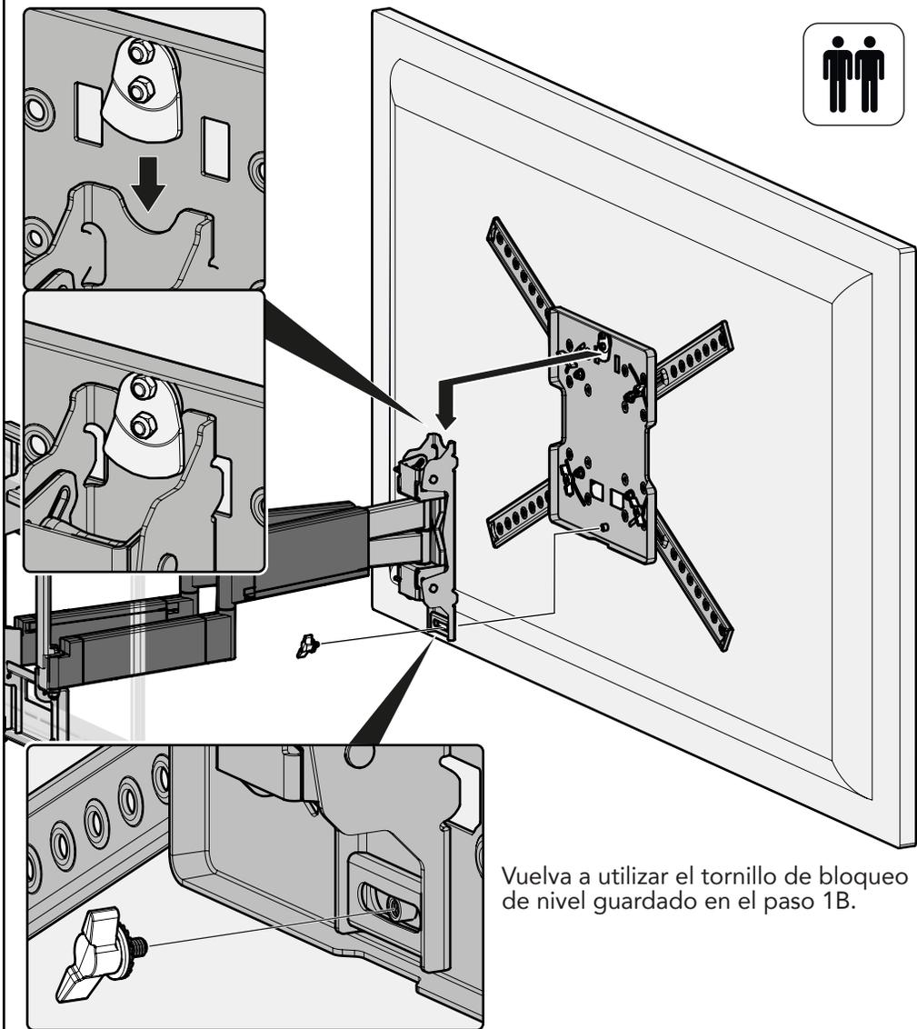
Vuelva a utilizar el tornillo de bloqueo de nivel guardado en el paso 1B.
