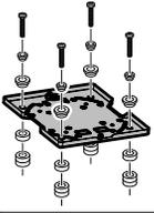
Si el VESA del televisor es de 200x200 mm o menos, utilice los orificios de la placa de montaje del televisor.
