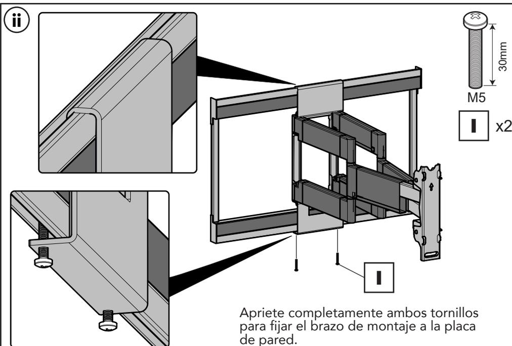
Apriete completamente ambos tornillos para fijar el brazo de montaje a la placa de pared.
