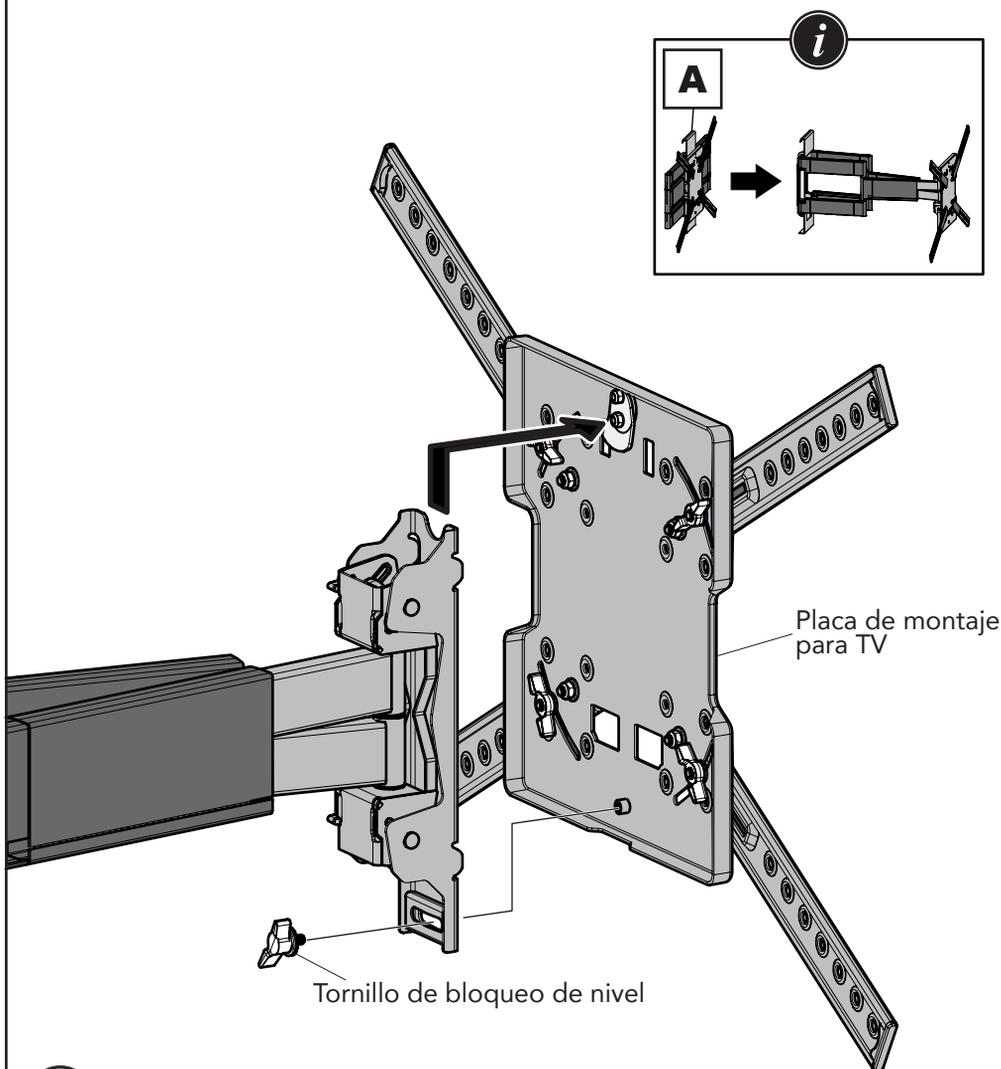
**i** Retire el tornillo de bloqueo de nivel y guárdelo de forma segura para cuando lo necesite en el paso 3A.
