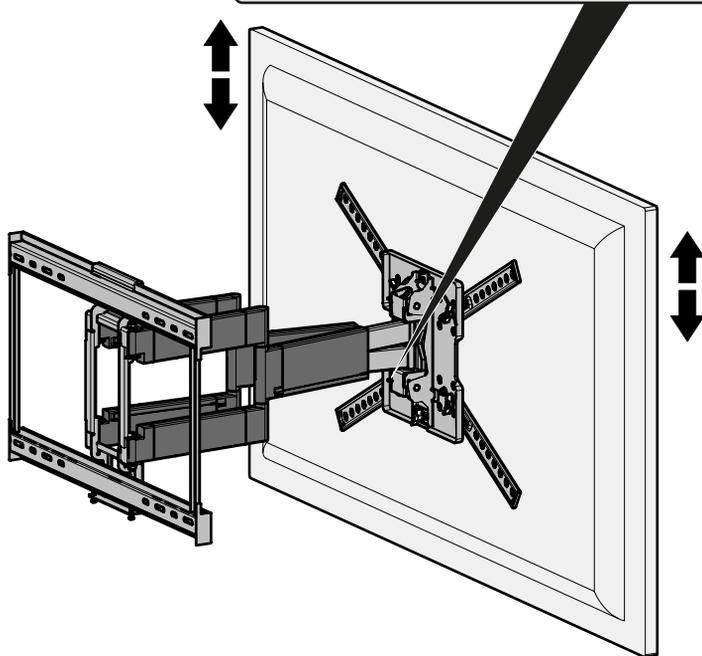
Afloje el tornillo de bloqueo de nivel, ajuste el televisor hasta que esté nivelado y, a continuación, vuelva a apretar el tornillo.
