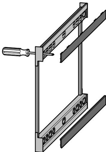
Retire las tapas del soporte de pared y guárdelas de forma segura para cuando las necesite en el paso 2C. Empuje las tapas del soporte de pared por detrás y hacia fuera con un destornillador.
