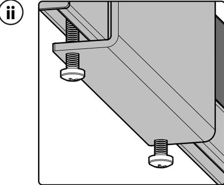
Deslice el brazo hasta la posición deseada y vuelva a apretar ambos tornillos de bloqueo. Vuelva a conectar su televisor.
