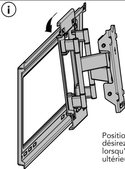
Positionnez le bras de montage à l'endroit où vous désirez que le centre de votre téléviseur soit placé, lorsqu'il est à plat contre le mur. Vous pouvez l'ajuster ultérieurement si nécessaire.
