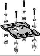
Si la norme VESA du téléviseur est de 200 x200 mm ou moins, utilisez les trous de la plaque de montage du téléviseur.
