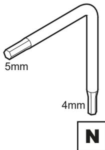
Desserrez la vis de serrage du niveau, ajustez votre téléviseur au niveau souhaité, puis resserrez la vis.
