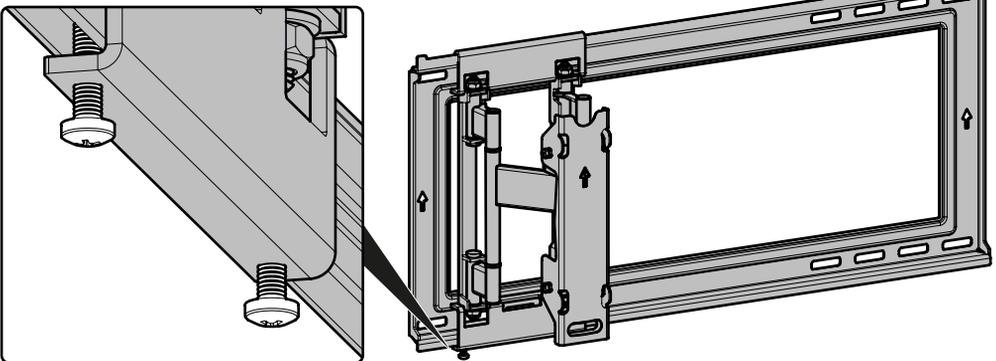
Glissez le bras en position et resserrez les deux vis de serrage.
