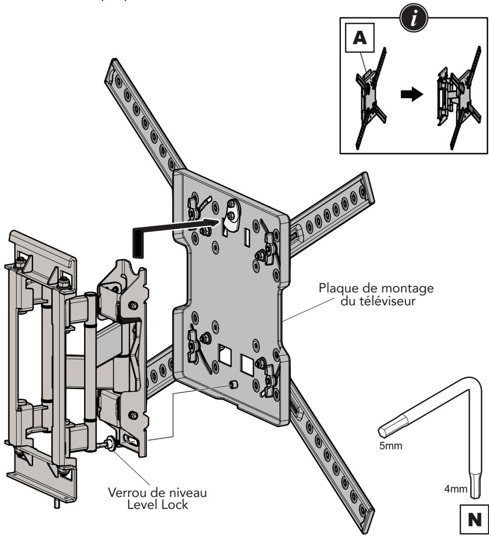
**i** Retirez la vis du verrou de niveau Level Lock et garder précieusement pour l'étape 3A.
