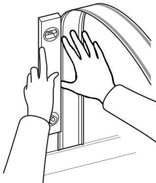
Utiliser un chiffon propre et sec pour appuyer fermement et frotter le long des canaux.
