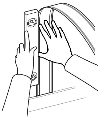
Use un paño limpio y seco para presionar firmemente y frotar a lo largo de los canales.
