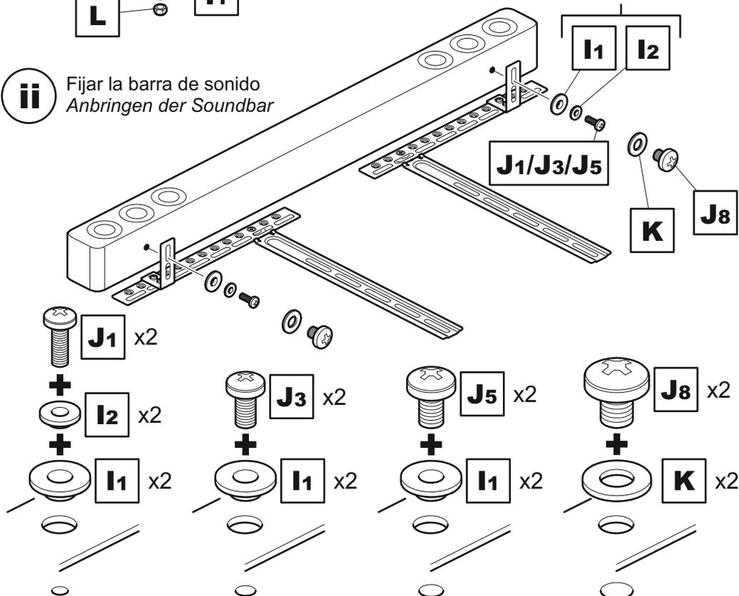
Coloque los soportes a la parte inferior de la barra de sonido usando la combinación adecuada de tornillo y reductor.
