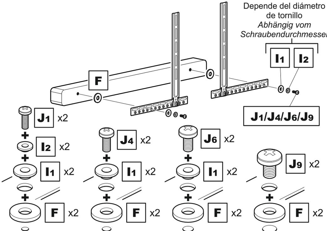
Coloque los soportes a la parte posterior de la barra de sonido usando la combinación adecuada de tornillo y reductor.
