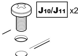
Coloque los soportes a la parte posterior de su TV usando la combinación adecuada de tornillo y reductor.
