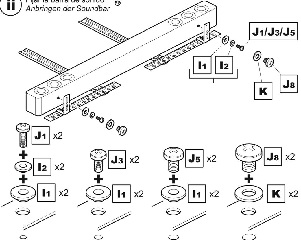
Coloque los soportes a la parte inferior de la barra de sonido usando la combinación adecuada de tornillo y reductor.
