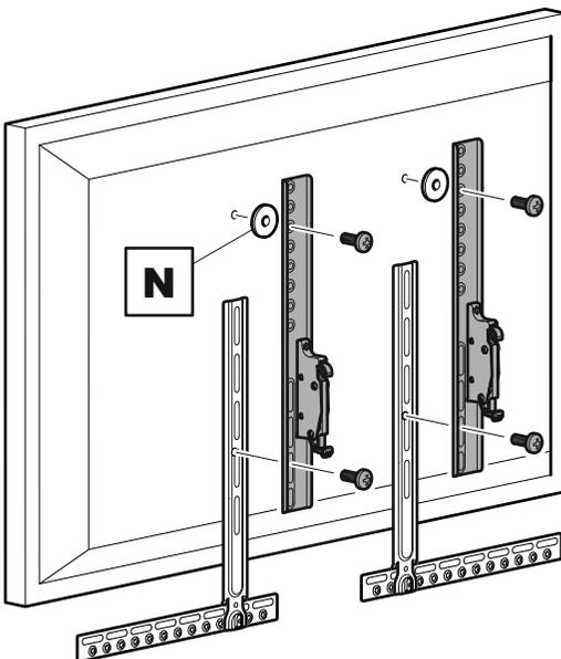
Si va a conectar la barra de sonido a una TV montada en la pared por favor utilice este paso junto con las instrucciones suministradas con su soporte de pared para TV.
