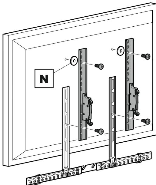
Si va a conectar la barra de sonido a una TV montada en la pared por favor utilice este paso junto con las instrucciones suministradas con su soporte de pared para TV. *Wenn Sie Ihre Soundbar an einem an der Wand montierten Fernseher anbringen, befolgen Sie bitte diesen Schritt in Verbindung mit den Anweisungen, die mit der Wandhalterung Ihres Fernsehers geliefert wurden.*
