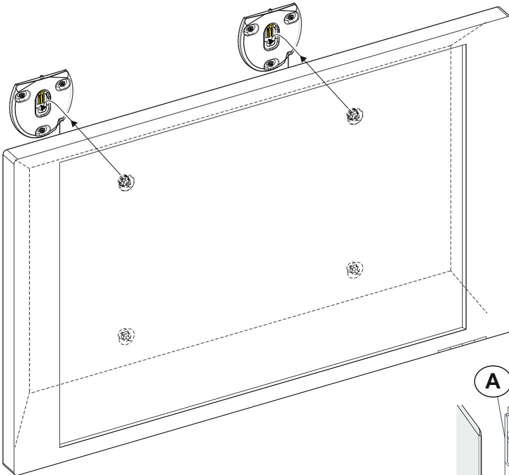
Presione los enganches amarillos (en la parte trasera de la TV) sobre el receptor amarillo en el soporte de la pared. Encájelo en su sitio. Asegúrese de que ambos enganches amarillos están acoplados. Si los cables impiden que la TV descansa sobre la pared entonces será necesaria una configuración alternativa (sección 11).
