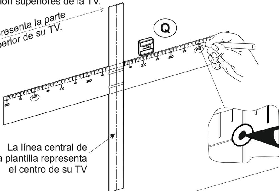
Después use el Soporte de la pared (A) como plantilla y póngalo sobre una de las MARCAS A LÁPIZ que ha hecho de modo que la marca quede en el centro del AGUJERO CENTRAL del Soporte (A). Asegúrese de que el soporte esté nivelado y marque los tres PUNTOS DE PERFORACIÓN con un lápiz. Repita lo mismo para los dos soportes.
