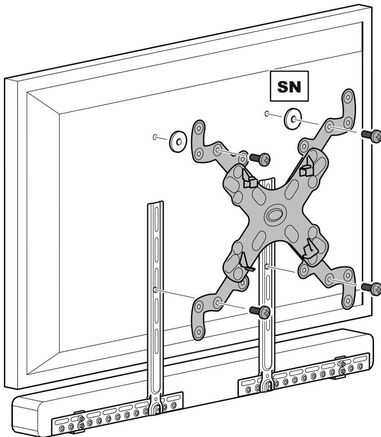
**10****Attaching the Soundbar with Hook and Loop****Montage du Soundbar au moyen des attaches velcro****i**
