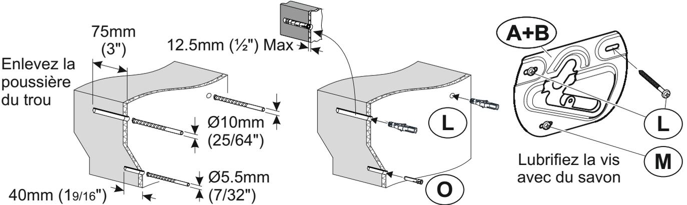
Caractéristiques de surface de soutien mini : - Placoplatre / plaques de plâtre de 1/2" d'épaisseur, montées sur des ossatures bois de 1/2" x 3 1/2" éloignées d'au moins 16".
