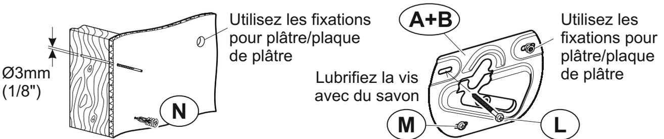
Une seule fixation sur le montant en bois. Les autres dans le plâtre/plaque de plâtre (voir ci-dessus).
