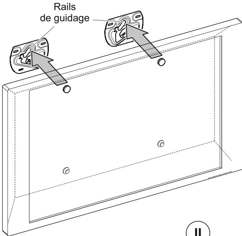
Présenter les accroches jaunes (à l'arrière de la TV) sur les rails de guidage des supports. Faites glisser votre TV vers le bas des rails de guidage. Assurez-vous que les 2 accroches jaunes soient totalement engagées. Si les câbles à l'arrière de l'écran empêchent la TV de reposer verticalement contre le mur, la configuration alternative des accroches est nécessaire.
