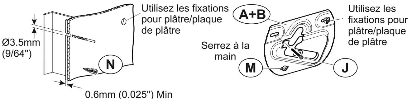
Une seule fixation dans le montant en métal. Les autres dans le plâtre/plaque de plâtre (voir ci-dessus).
