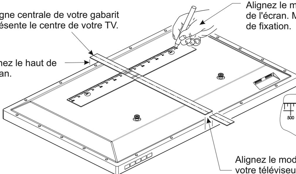
Alignez le modèle sur le bas de votre téléviseur, afin de voir exactement la disposition verticale de celui-ci (distance du sol et du plafond).
