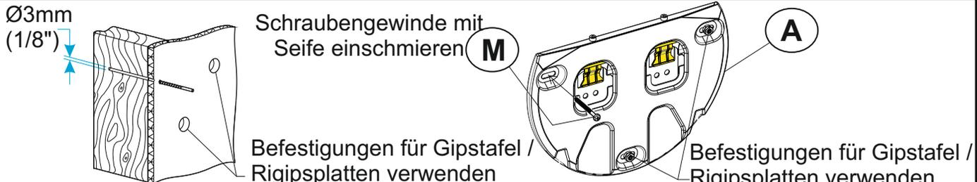
Im Holzbolzen befindet sich nur eine Befestigung. Die anderen Befestigungen sind in Gipstafel / Rigipsplatten (siehe oben).
