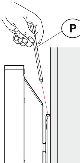
Verwenden Sie den 3mm Sechskantschlüssel (P), um die Höhe des TVs leicht zu verändern, wenn er an der Wand hängt.
