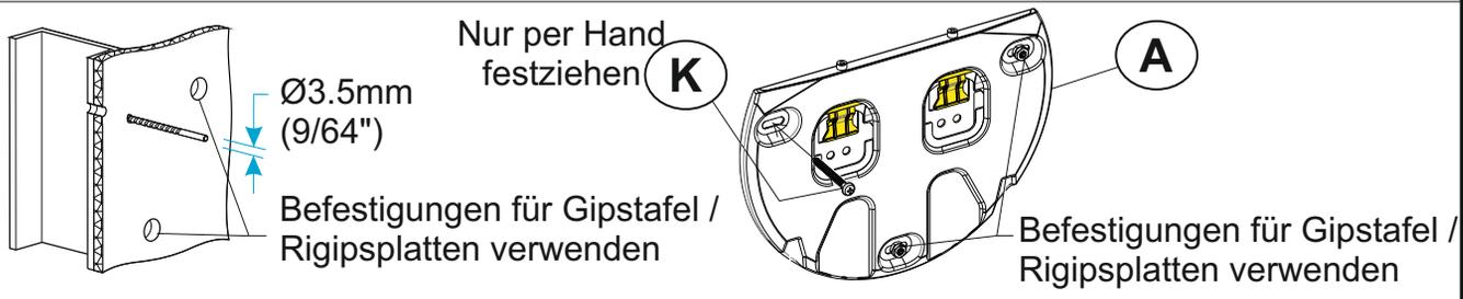
Im Metallbolzen befindet sich nur eine Befestigung. Die anderen Befestigungen sind in Gipstafel / Rigipsplatten (siehe oben).
