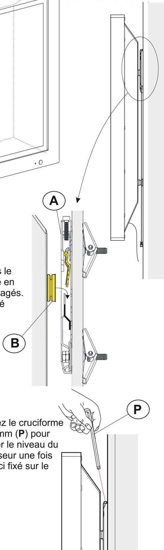
Utilisez le cruciforme de 3 mm (P) pour ajuster le niveau du téléviseur une fois celui-ci fixé sur le mur.
