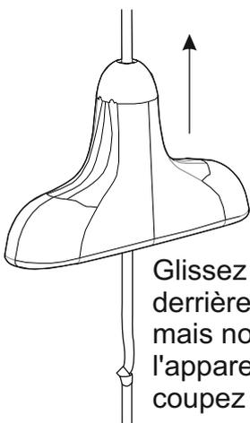
Glissez les fixateurs de câbles derrière le téléviseur (accessibles mais non visibles de l'avant de l'appareil). Nouez le fixateur et coupez l'excédent.
