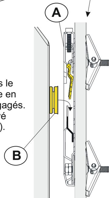
Utilisez le cruciforme de 3 mm (N) pour ajuster le niveau du téléviseur une fois celui-ci fixé sur le mur.
