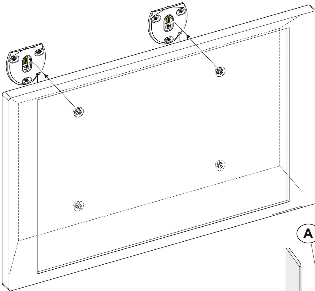
Poussez les crochets jaunes (à l'arrière du téléviseur) dans le réceptacle jaune des crochets muraux. Glissez pour mettre en place. Assurez-vous que les crochets jaunes sont bien engagés. Si les câbles du téléviseur empêchent celui-ci d'être appuyé contre le mur, envisagez une autre fixation (voir section 11).
